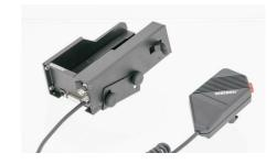
Funkgerät zu verbinden. Die Ladehalterung wird mit den seitlichen Anschlüssen des Funkgeräts verbunden, sodass über das mitgelieferte Handmikrofon kommuniziert werden kann. Während Ihr Funkgerät in der Ladehalterung genutzt wird, stehen Ihnen zusätzlich die Funktionen Schnellladung und Ladeerhaltung zur Verfügung. Über den SUB-D Stecker kann weiteres Zubehör angeschlossen werden. Die Ladehalterung wird am Bordnetz angeschlossen.
